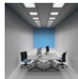
La classica soluzione dell'illuminazione d'ufficio con apparecchi a incasso e ottica parabolica garantisce un'illuminazione sufficiente del posto di lavoro, ma la parte superiore delle pareti e il soffitto rimangono scuri. Ciò si traduce in un effetto grottesco che rende la stanza otticamente più piccola. Un tale sistema di illuminazione non soddisfa i requisiti LG7.
