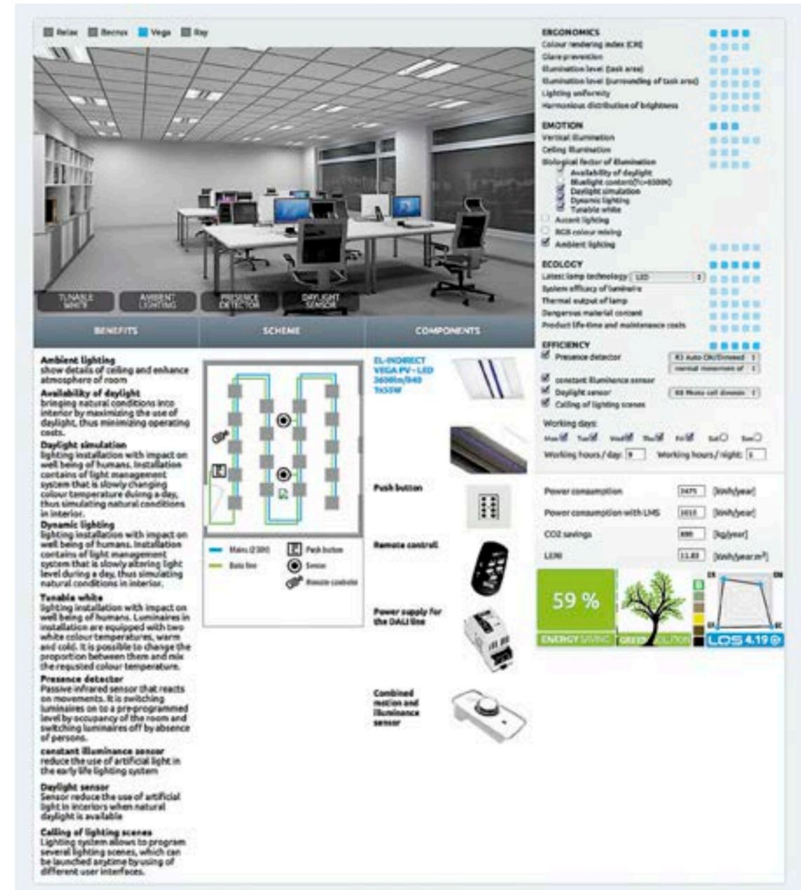
Gli apparecchi utilizzati sono l'equivalente LED dei classici quadrati a incasso di dimensioni 600x600 mm. Grazie alla particolare forma della parte ottica, questo tipo di apparecchi ha un'ampia curva di intensità luminosa che assicura una sufficiente illuminazione verticale.
